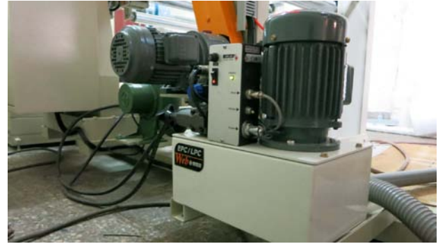
Kontrolör Seri 49 direk TOUGU DENKI Hidrolik Aktüatör üzerine yüklenmektedir.
